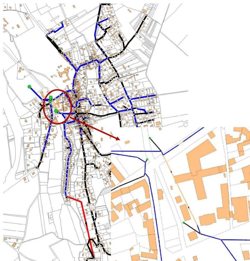
Figure 16 : Résultat de la simulation présentant l'absence de déversements pour une pluie courante (mensuelle)
