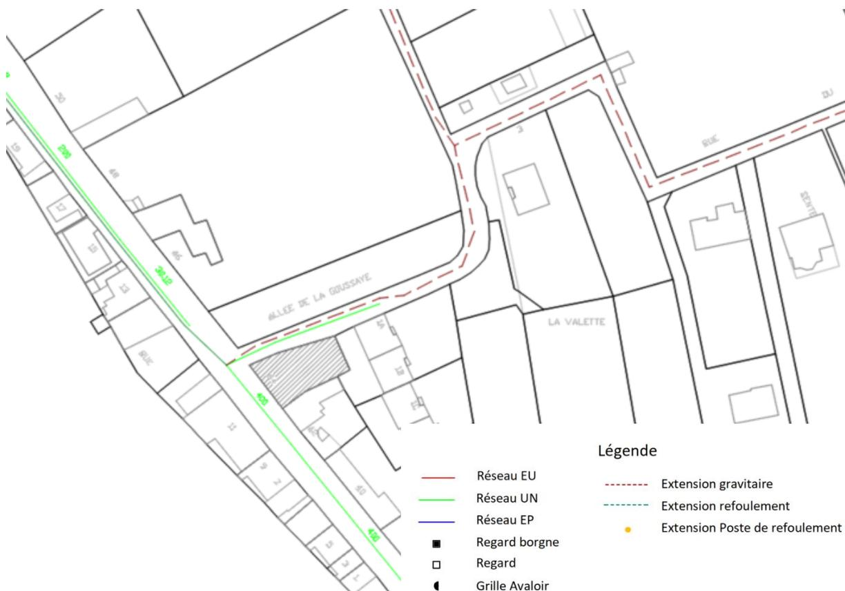
Figure 2 : Projet de raccordement de l'allée de la Coussaye au réseau d'assainissement collectif
